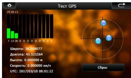
В данном окне представлена информация о вашем местоположении: координаты широты и долготы в градусах, высота над уровнем моря и т.п. В правой части экрана показаны спутники, сигнал от которых принимает устройство, а гистограмма в левой части экрана показывает мощность принимаемого сигнала каждого из спутников.
