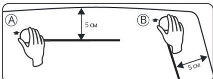
4. Протяните антенный кабель под резиновым уплотнителем по периметру стекла и опустите его вниз. Либо проложите кабель под декоративной накладкой боковой стойки.
