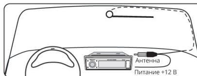
7. Подключите штекер антенны к разъёму ANT на головном устройстве.
