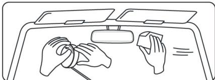
3. Отделите защитную пленку с корпуса антенны и прижмите антенну к ветровому стеклу, параллельно его кромке. На рисунке ниже представлены 2 наиболее оптимальных варианта места установки антенны (A и B). Рекомендуется устанавливать антенну на расстоянии 5 см от края стекла.
