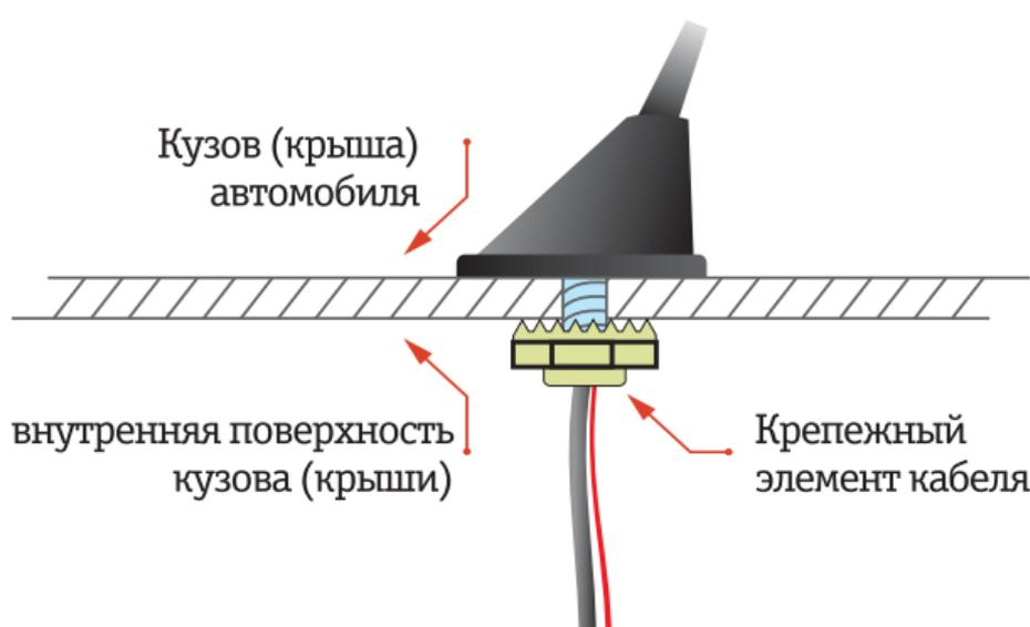
Зубчатая шайба должна соприкоснуться с металлической поверхностью кузова.
